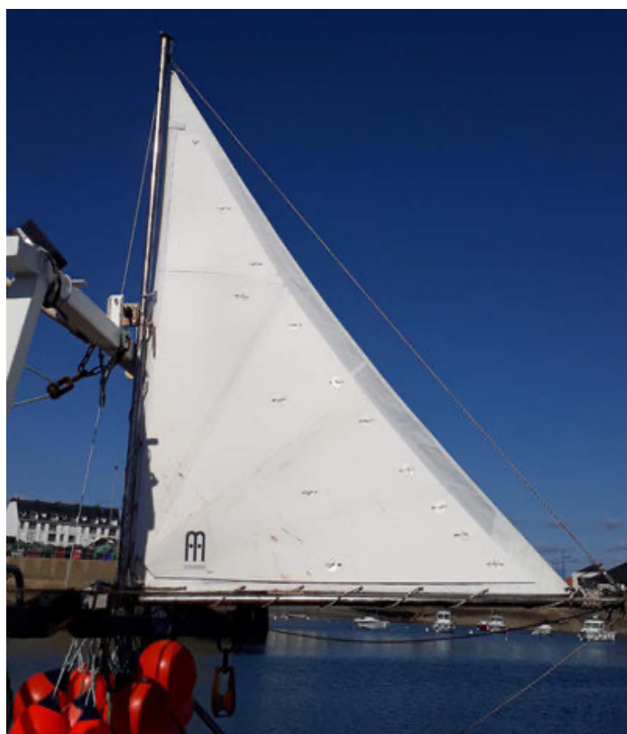
Add technologies a installé une voile tape-cul à l'arrière d'un petit palangrier de Quiberon.
